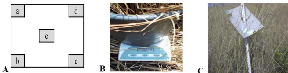
Légende : A : placettes de prélèvement de biomasse (a, b, c, d, e) ; B : balance de pesée (Type CAMRY, Model : EK 3252, Max : 5 kg/11 lb, d = 1 g / 0.05 oz) ; C : herbomètre gradué.
