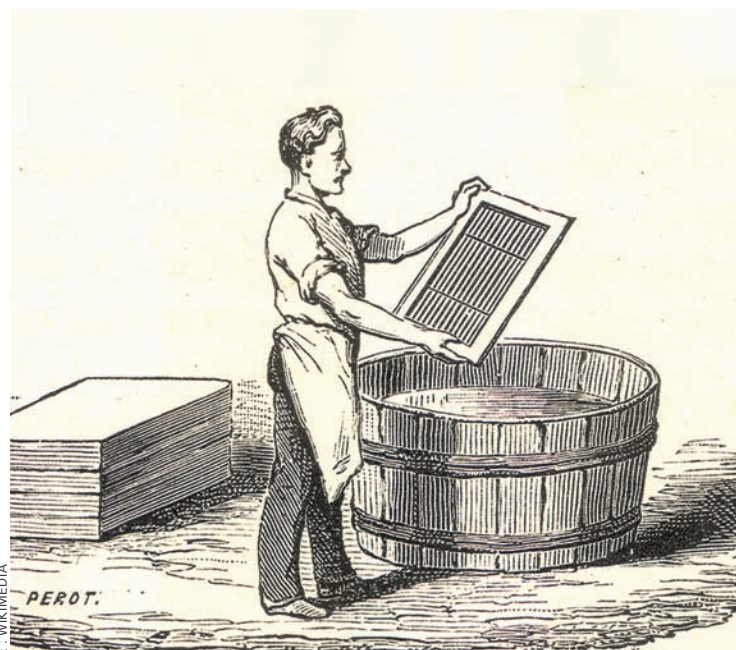
Fig. 97. — Fabrication d'une feuille de papier.
