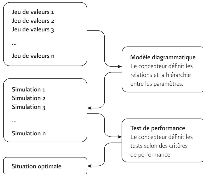
**Figure 2.** Schéma du design orienté sur la performance.
