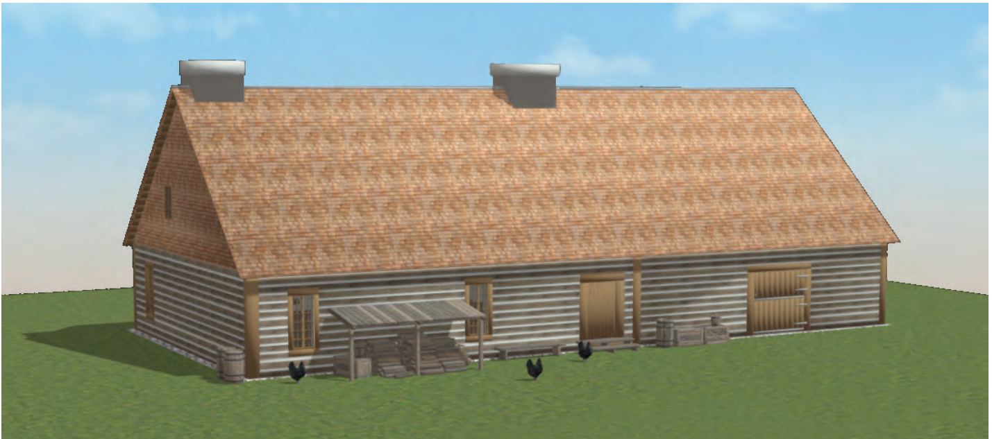
Reconstitution de l'ensemble agricole des Bellanger (1716-1757). Le bâtiment est illustré sans crépi afin de présenter la technique de construction en pièce sur pièce.
