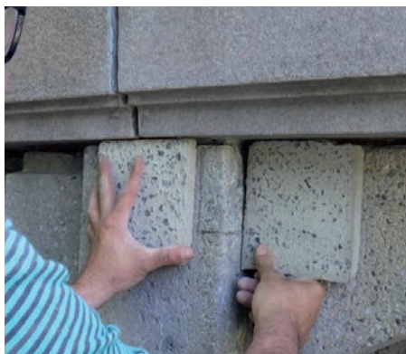
L'équipe a préparé différents échantillons de béton pour trouver le mélange idéal.
