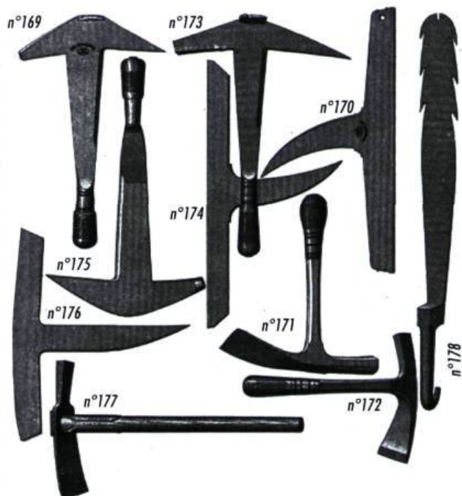
Outils du couvreur présenté dans l'Album de Goldenberg et Cie (XIXe siècle) : 169, marteau façon Angers ; 170, enclumette façon Angers ; 171, essette façon Angers ; 172, essette façon Paris ; 173, marteau façon Paris ; 174, enclumette façon Paris ; 175, marteau façon Alsace ; 176, enclumette façon Alsace ; 177, marteau ; 178, tire-clous.
