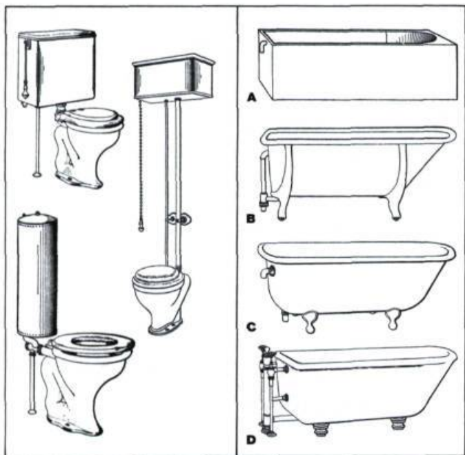
Les trois types de réservoirs. (Planche tirée de Encyclopedia of Architecture, Carpentry and Building , Chicago, 1909, American School of Correspondence.)
