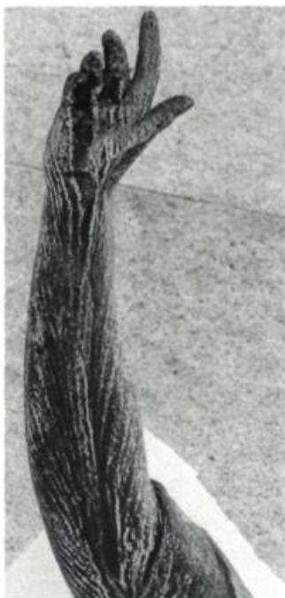
Un bras strié de brochantite, un sulfate de cuivre. Monument Dollard-des-Ormeaux à Montréal. (photo: J.R. Morissette)
