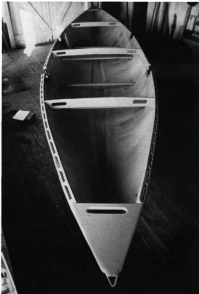
6. Le produit fini. Pour solidifier le canot, on a mis en place le bandeau, qui forme une ceinture solide à l'intérieur du navire, les barres à mains et à pieds et les bancs, qui maintiennent l'écartèlement de la coque, puis les toiletières, qui accueillent tolets et rames. (photo: S. Drolet)
