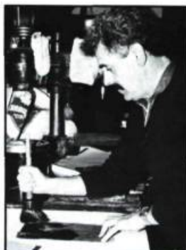
6 Amincissement ou parage du cuir pour en faciliter le collage sur le dos du volume.
