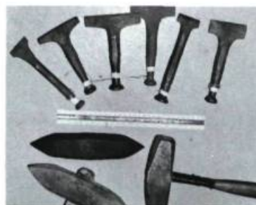
7 Différents ciseaux droits utilisés pour ciseler ou peigner la pierre, ainsi qu'une masse et deux pics.
