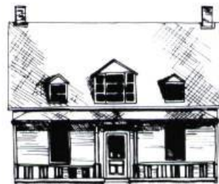
Habitation de bois revêtue de planche à déclin (toit de tôle à la canadienne).
