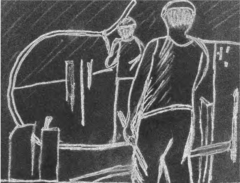
**Fig. 3.** Dessin interprétatif réalisé à partir d'un photogramme tiré du film *Acciaio* de Walter Ruttmann (1933). © Nadège Mariotti. Vue partielle d'un train de laminoir. L'ouvrier du premier plan saisit une billette incandescente (non visible sur le dessin) qu'il introduit dans une cage. L'autre ouvrier, au second plan, s'en saisit avant de l'introduire à son tour dans la deuxième cage.
