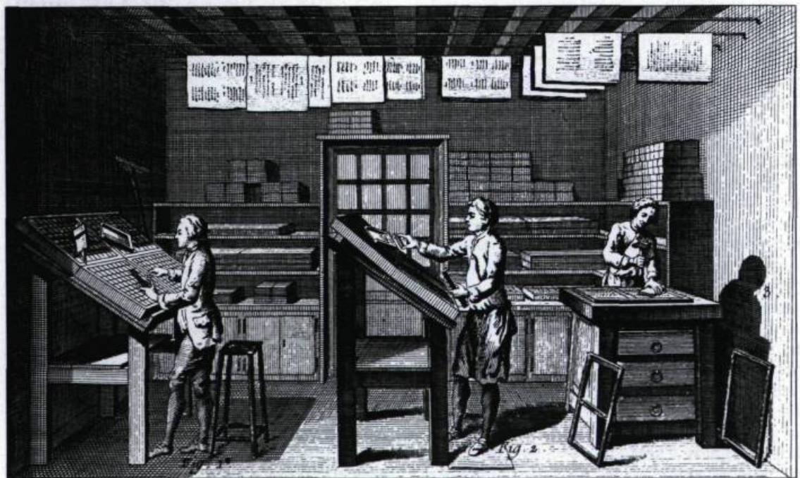
Atelier de composition. Après chaque ligne du manuscrit complétée et justifiée, le typographe la place dans une galée, sorte de casier long et étroit, à partir de laquelle on tire une première «épreuve sur galée».
