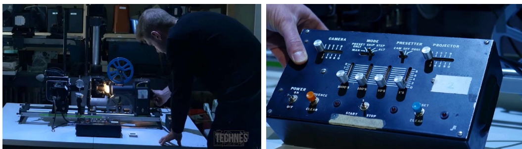
Une tireuse optique JK, ici utilisée avec un séquenceur et une caméra Bolex H16; images tirées d'une démonstration faite par le cinéaste Philippe Léonard dans les locaux de Double Négatif. Voir la fiche .
