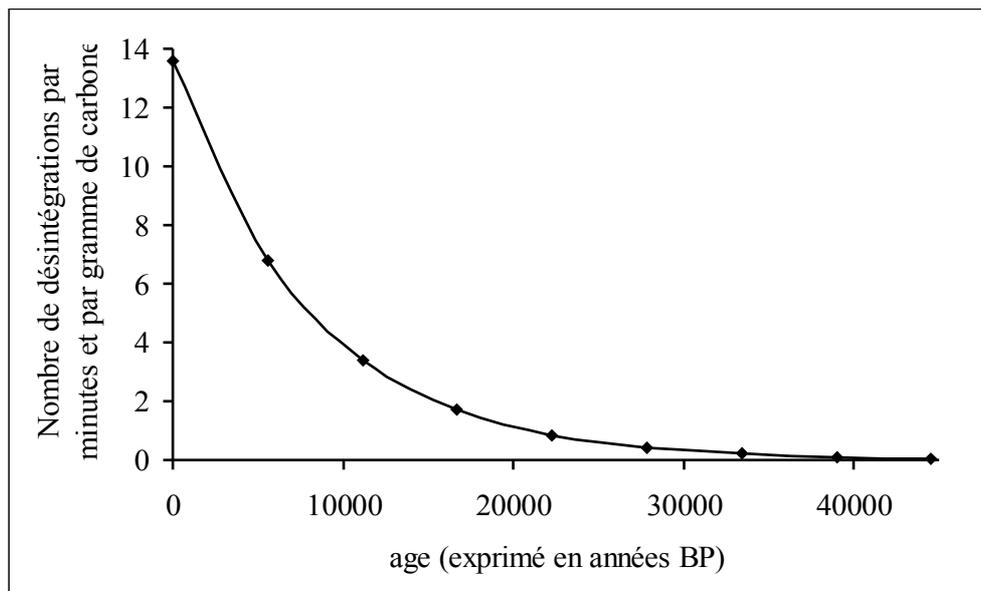
**Figure 4.** Courbe de décroissance radioactive du  $^{14}\text{C}$
