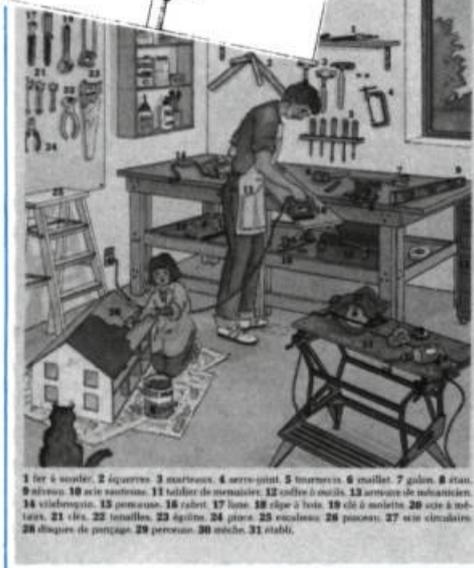
1 fer à souder, 2 équerres, 3 marteaux, 4 serre-joint, 5 tournevis, 6 marteau, 7 gâche, 8 état, 9 niveau, 10 axe roulement, 11 tableau de menuiserie, 12 coffres à outils, 13 seringue de menuisier, 14 vilain, 15 perceuse, 16 rabot, 17 lime, 18 ciseau à bois, 19 clé à molette, 20 axe à molette, 21 clés, 22 tenailles, 23 égare, 24 pince, 25 couteau, 26 pinceau, 27 sceau circulaire, 28 disque de ponçage, 29 perceuse, 30 mèche, 31 établi.
