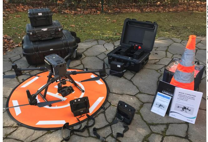
Figure A7. Matériel utilisé pour les inventaires par drone (quadricoptère DJI Matrice 300 RTK) en 2021.
