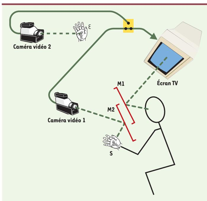
Figure 1. Dispositif de E. Daprati *et al.* [8] permettant de substituer la main d'un expérimentateur à celle du sujet. S: sujet; E: expérimentateur; M1, M2: miroirs permettant la visualisation de la main du sujet par l'intermédiaire du système vidéo.
