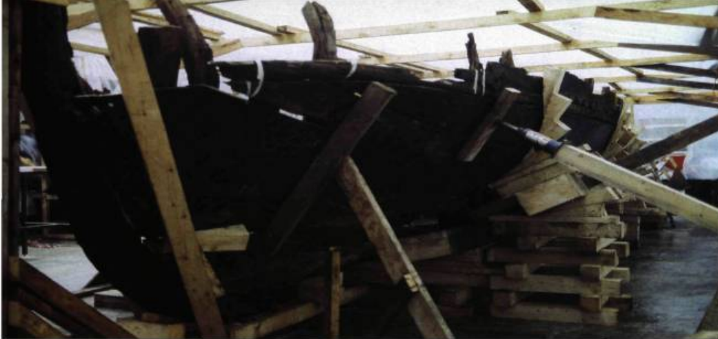
L'embarcation à voile est remise en forme à l'aide de gabarits et de supports temporaires.
