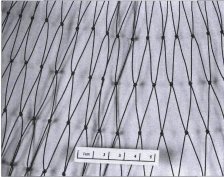
*Le textile est constitué de monofilament de nylon 6-6. Cette fibre synthétique a l'avantage de ne pas propager le feu.*
