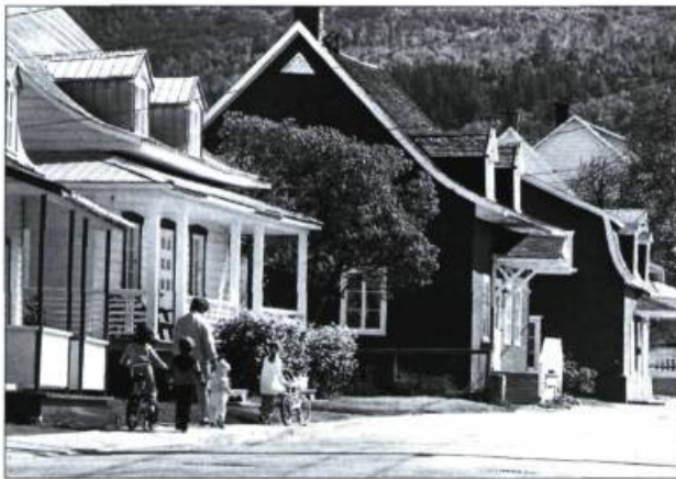
La rue Saint-Joseph conserve son homogénéité architecturale du XIX e siècle. Ici, deux maisons à toit à deux versants et une au toit à la mansarde.
