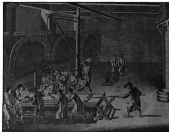
4. Gravure illustrant le troisième procédé du coulage du verre en fusion sur une table de métal aux bordures surélevées. (photo tirée de: «Encyclopédie de Diderot et d'Alembert», XVIII e siècle)
