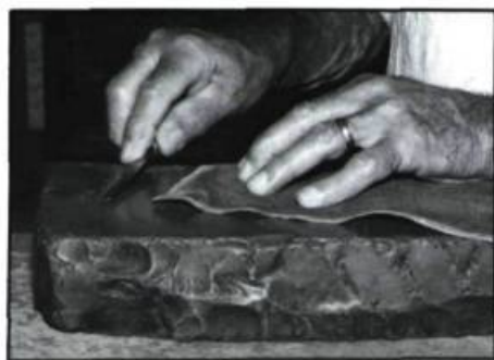
6 Amincissement ou parage du cuir pour en faciliter le collage sur le dos du volume.
