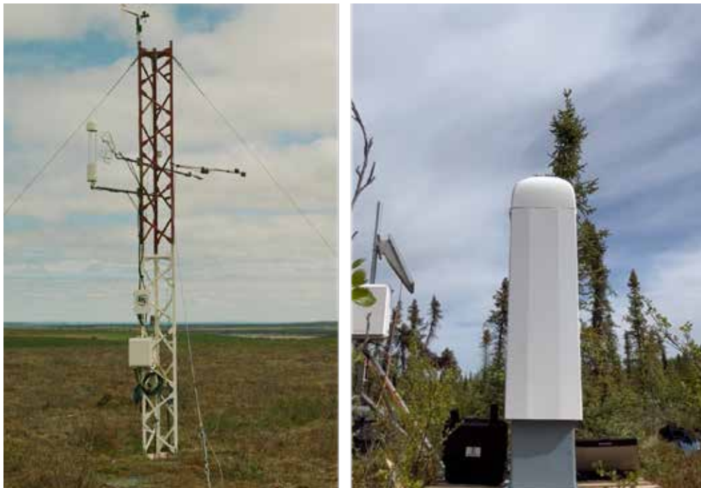
Figure 1. Instruments de mesure pour l'analyse des changes de matière et d'énergie entre sol et ciel. À gauche : tour de covariance des turbulences ; à droite : célomètre. Source : Bruno Lecavalier.
