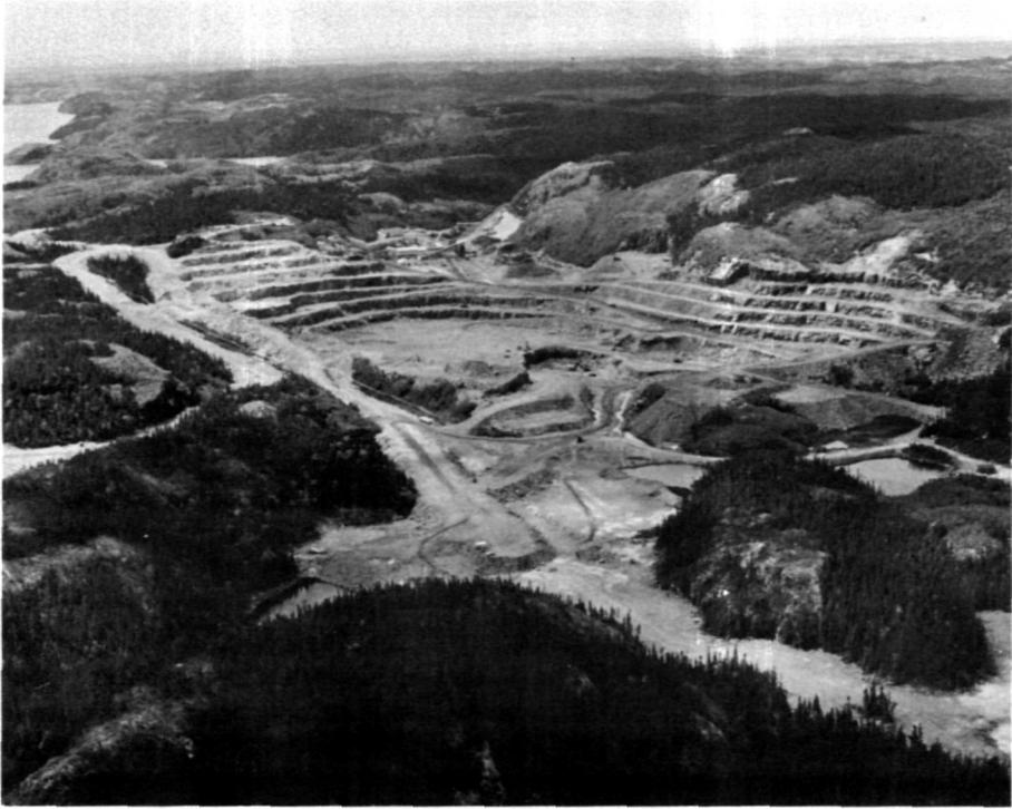
**Photo 1** L'exploitation minière de la société F.T.Q. aux lacs Allard-Tio. Extraction à ciel ouvert par la méthode de « gradins ». Dans la partie supérieure gauche, l'usine de concassage, le bâtiment administratif et le terminus de la voie ferrée. Plus à l'ouest, une partie du lac Allard. À remarquer également la sub-horizontalité du plateau laurentien.
