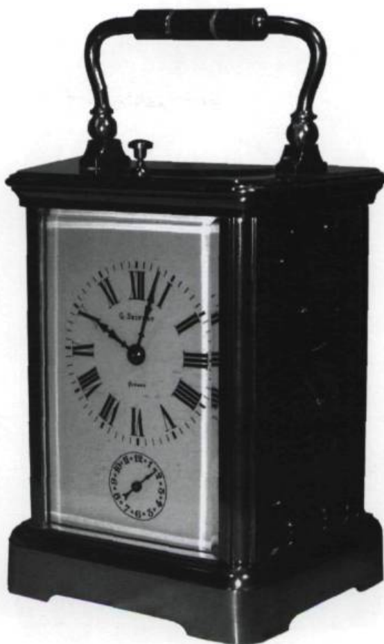
Pendule d'officier signée G. Seifer, Québec, vers 1900. Cette horloge transportable est munie d'une sonnerie à répétition. En pressant le poussoir du dessus, la sonnerie permet de déterminer l'heure et le quart d'heure. (Collection Daniel Pelletier).
