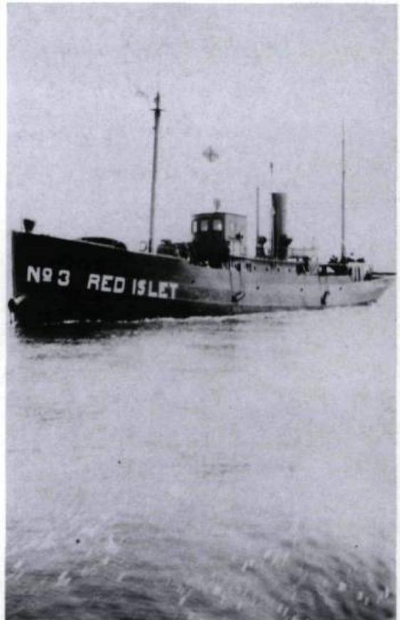
Comment différencier un bateau-phare d'un vaisseau ordinaire? Le bateau-phare se distingue des autres navires par ses mâts dénués de voiles et couronnés de fanaux. Il s'agit soit de vieux voiliers, soit de navires de guerre. Longs d'une quarantaine de mètres et munis d'un moteur en cas de détresse, ces feux flottants s'acquittent doublement de leur tâche en cas de mauvais temps: s'il y a du brouillard, une génératrice à vapeur met en fonction le sifflet de brume.
